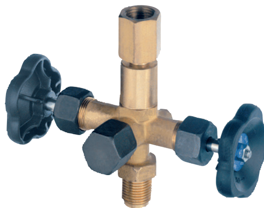
Zawór odcinający z izolowanym przyłączem testowym wg DIN 16 272, nakrętka/ zew. G ½, ze złączem testowym M 20 x 1,5, PN 400
