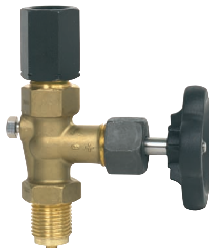
Zawór odcinający wg DIN 16 270, nakrętka/ przyłącze zew. G ½, PN 250
